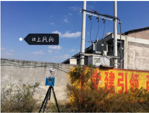
图 6-2 项目无组织废气采样图
