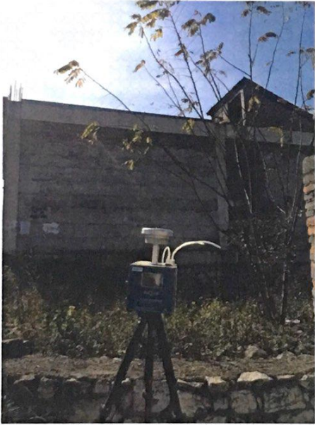
现场无组织废气采样图
